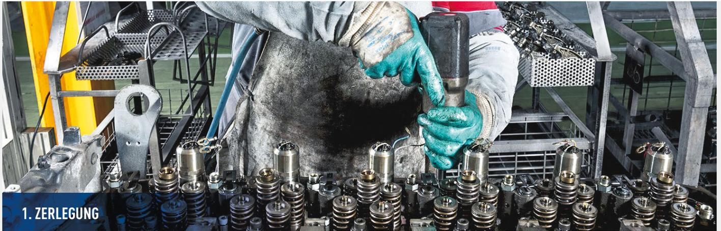
Alle ausgebauten Teile werden komplett für die Inspektion zerlegt.
