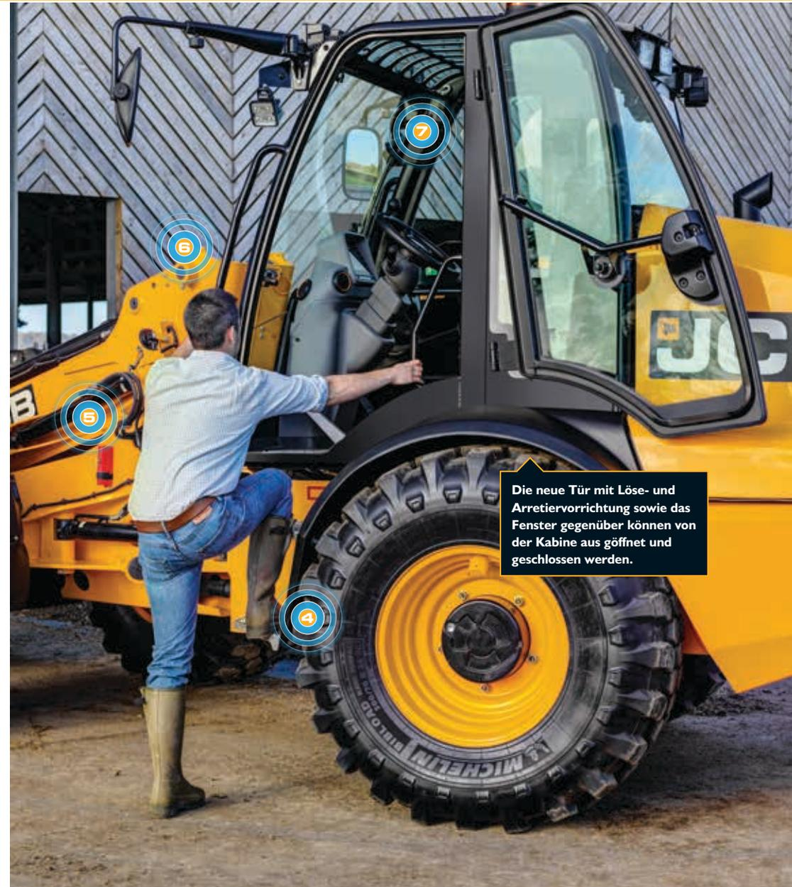
Die neue Tür mit Löse- und Arretiervorrichtung sowie das Fenster gegenüber können von der Kabine aus geöffnet und geschlossen werden.
