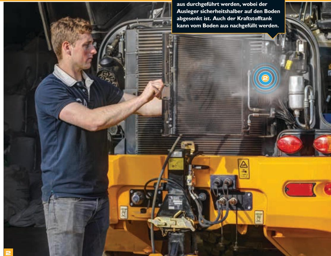
Tägliche Kontrollen können vom Boden aus durchgeführt werden, wobei der Ausleger sicherheitshalber auf den Boden abgesenkt ist. Auch der Kraftstofftank kann vom Boden aus nachgefüllt werden.
