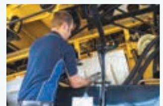
Die Kunststoff-Rotorabdeckungen können ohne Werkzeug demontiert werden.
