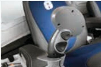
Umschalttaste und Entsperrung des Fahrhebels (hinten).
