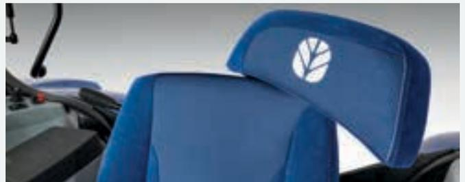
Sowohl die Dynamic Comfort™- als auch die Comfort-Sitze verfügen über eine neue ausziehbare Rückenlehne, die der oberen Rückenpartie zusätzlichen Halt gibt und den Komfort erheblich verbessert, wenn der Sitz gedreht wird, um die Heckanbaugeräte zu kontrollieren.
